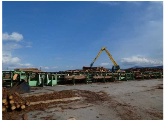
静岡原木流通センター(木質バイオマス証明認定事業者)。面積は約1ha。原木は3Dスキャナーで測定し自動選別している。
